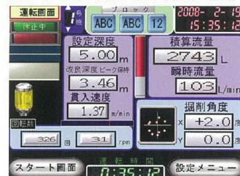
■施工管理装置「深度・流量・回転数・傾斜」
