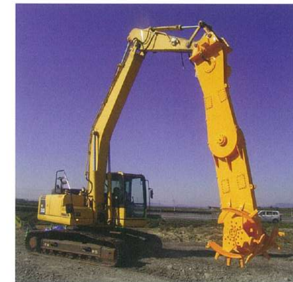
ブームランプレート装着でN値38の礫混じり砂層に対応
