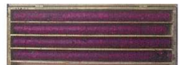
フェノールフタレイン散布後
